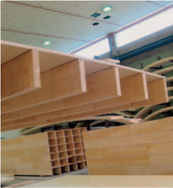
Fertig abgebundenes Rippenelement
